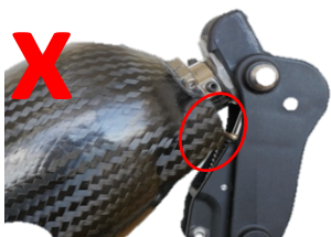
Fig. 15 Malpositioned Flexion Stop
